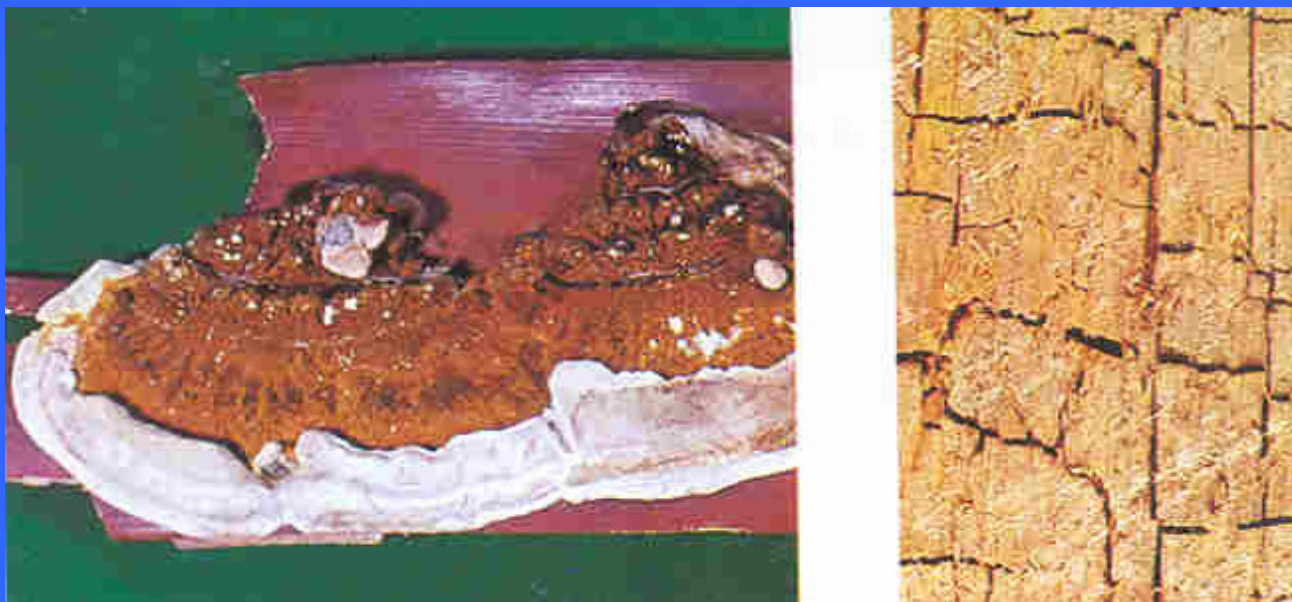
Dřevomorka domácí (vpravo jí způsobená škoda)
